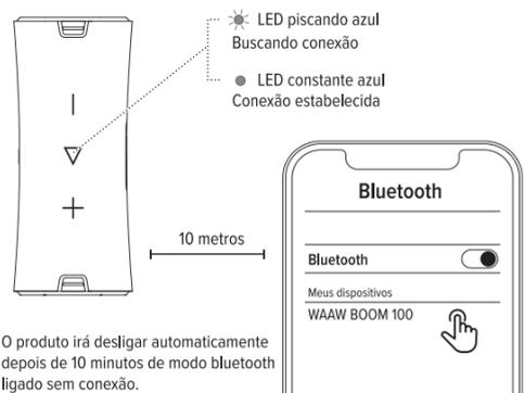
O produto irá desligar automaticamente depois de 10 minutos de modo bluetooth ligado sem conexão.
