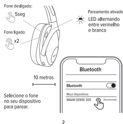
Todas as vezes que ligar os fones de ouvido ele vai se conectar automaticamente ao último dispositivo pareado. O fone de ouvido irá desligar automaticamente depois de 10 minutos de modo bluetooth ligado sem conexão.
